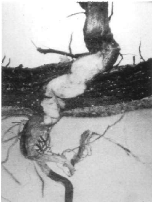
4.5 Perforación producida por raíces de cardos en una membrana asfáltica de cerca de 15mm de espesor, después de 15 meses de duración del ensayo (Pennigsfeld et al. 1981)
