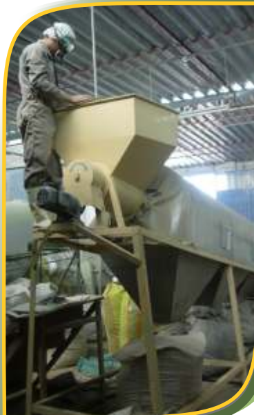
Limpieza y clasificación neumática
