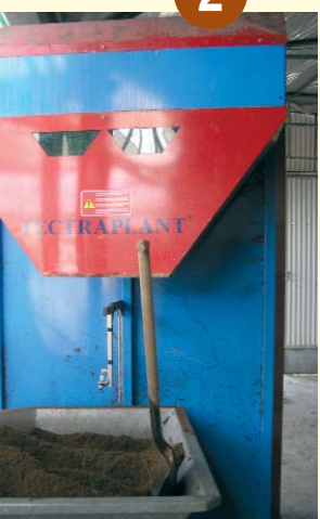
Tolva distribuidora de sustrato. El sustrato ecológico viene en sacos que se vierten directamente a la tolva
