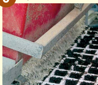
Cubrición de la bandeja con perlita para proteger la semilla y conservar la humedad
