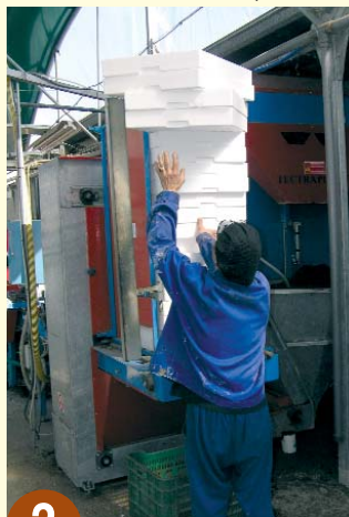
Alimentador de bandejas. Desde aquí las bandejas avanzan por medio de una cinta transportadora
